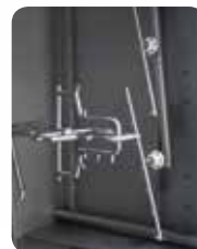
Conjunto de inyectores distribuido para alcanzar todas las áreas de lavado.
