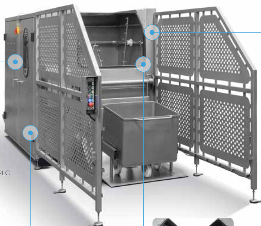
Conjunto de inyectores distribuido para alcanzar todas las áreas de lavado. Set of nozzles distributed to reach all areas to be washed.
