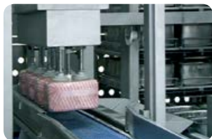
3. Desmoldeo automático Automatic unmoulding
